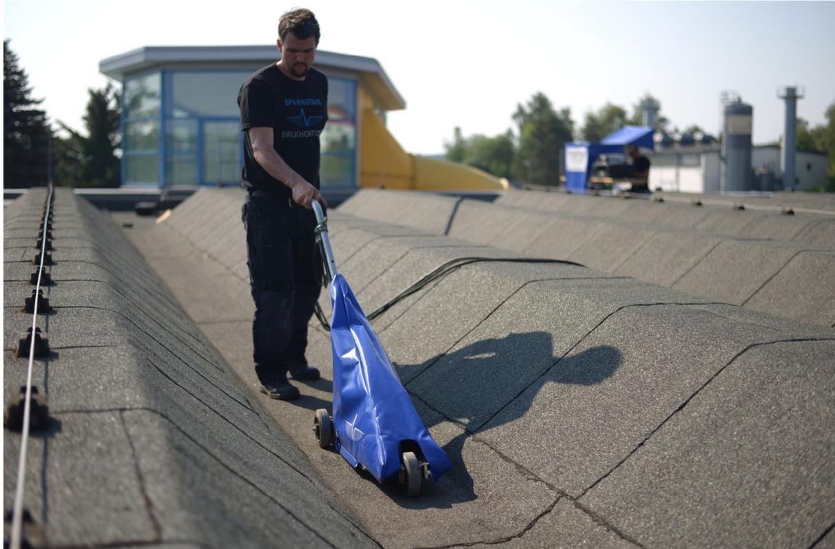
**Bild 3: Untersuchung von VT-Falten einer Schwimmhalle.**
